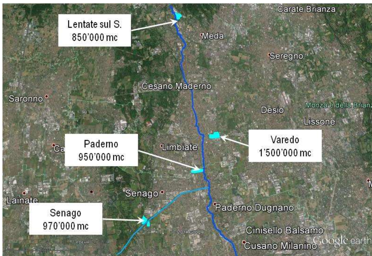
Figura 21 - Invasi di laminazione in scavo da Lentate sul Seveso al CSNO
