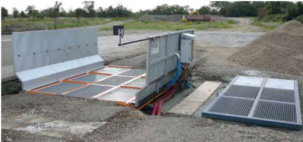
Figura 93 – Esempi di sistema fisso per pulizia idraulica delle ruote dei mezzi d'opera
